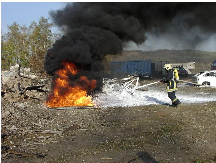
**Abbildung 3-2:** Flüssigkeitsbrand – Vornahme CAFS-Rohr [WU1]
