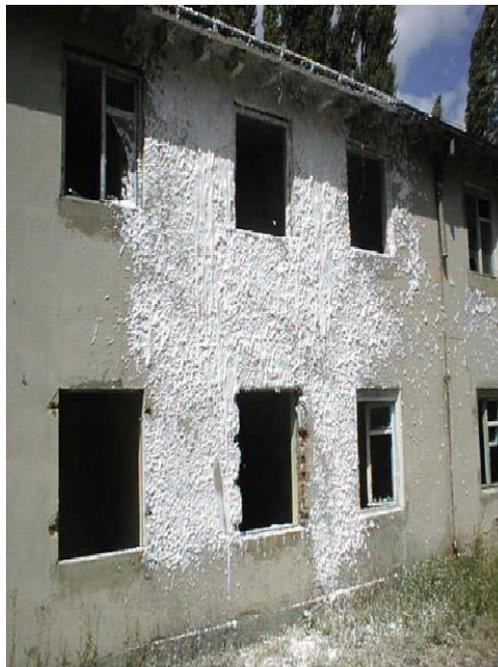
**Abbildung 3-6:** mit trockenem Schaum beaufschlagtes Gebäude [SM1]
